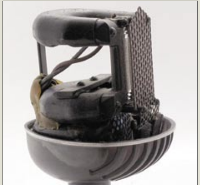
En Western Electric 639B utan övre delen av skyddskåpan. Nederst syns det blågröna membranet på den rundtagande mikrofonen och ovanför syns det veckade aluminiumbandet i bandmikrofonen.
