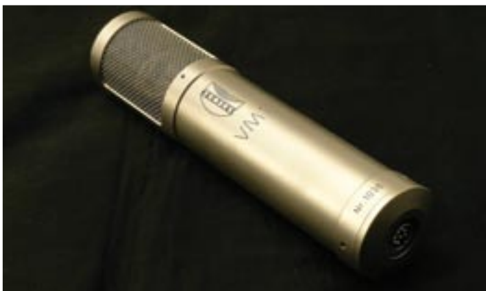
Bild3: Rörbestyckade kondensatormikrofoner har specialdesignade nät-aggregat. Brauner VM1 har en flerpolig kabel med specialkontakt till ett speciellt nätaggregat.
